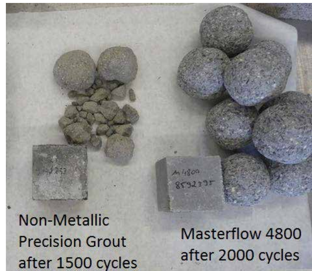
Figur 3. Brukprover efter 1500 och 2000 cykler.
