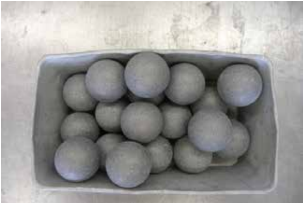
Figur 2. Stålkulor används för stötar.
