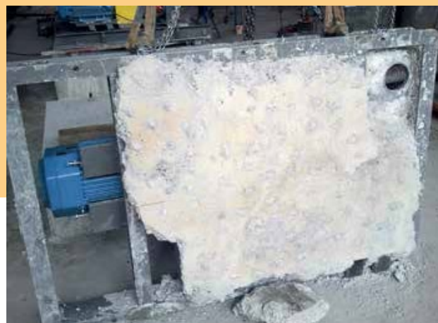
Усадка (вибрации при работе, как следствие, демонтаж оборудования)
