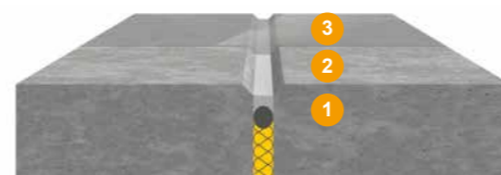
Selagem de juntas horizontais com tráfego
