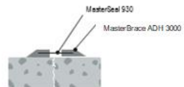
Selagem de fissuras
