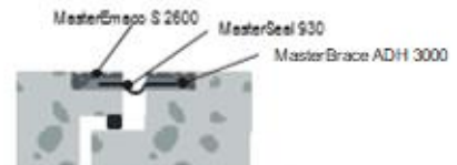
Selagem de juntas de dilatação específicas
