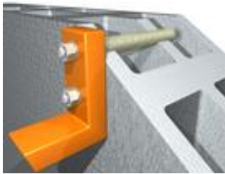
Fixação em blocos vazios
