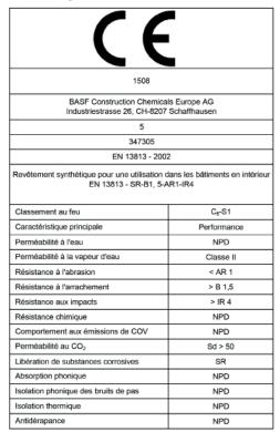
NPD : Performances non détérminées Performances mesurées dans le système MasterSeal Roof 2263
