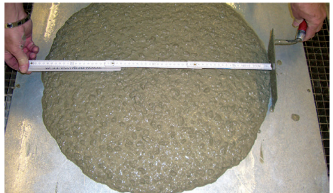
Pruebas de calidad del concreto lanzado
