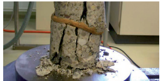
Revestimiento monolítico - Puenteo de fisuras
