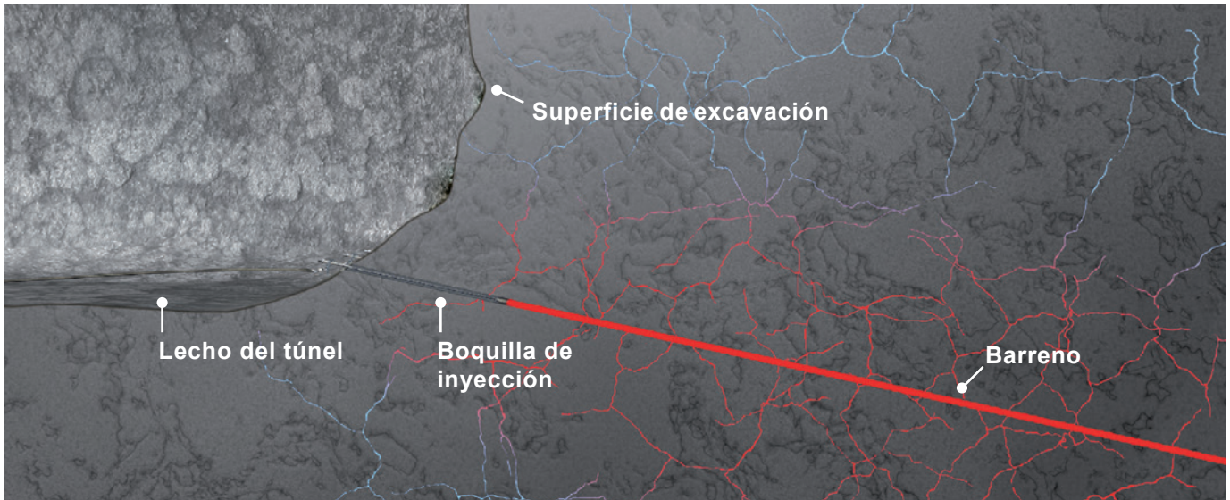
Microcemento estable penetrando las fisuras
