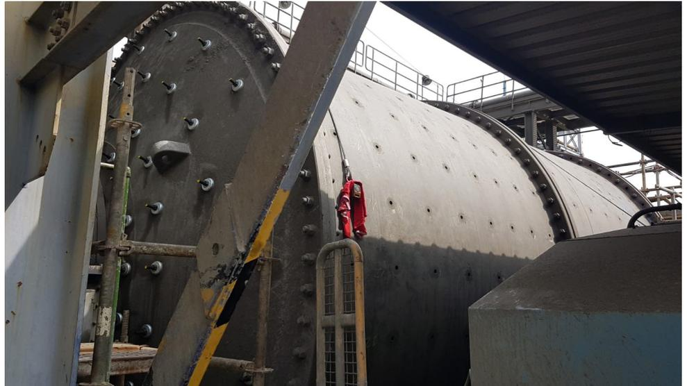
Imagen de molino de bolas empleado en el proceso productivo de una empresa minera
