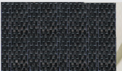
4. Utilizando cizallas o una cuchilla de uso general, corte secciones de tamaño apropiado de la lámina de fibra seca.
