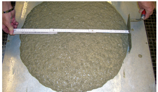
Pruebas de calidad del concreto lanzado
