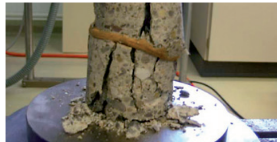
Revestimiento monolítico - Puenteo de fisuras
