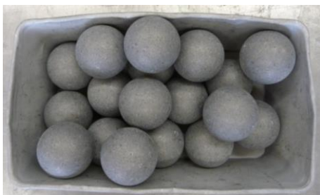
Stahlkugeln, die zusammen mit den Prüfkörpern in die Trommel gegeben werden
