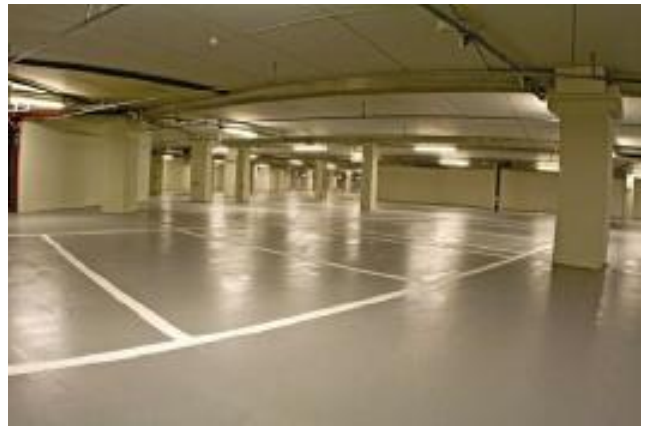
Vores reference: MasterSeal Traffic 2266 belægningen er både slidstærk og resistent overfor brændstof, salte m.m.
