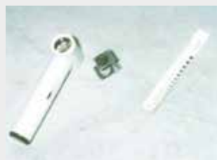
Revnebredden måles på overfladen med en speciel revnelup.
