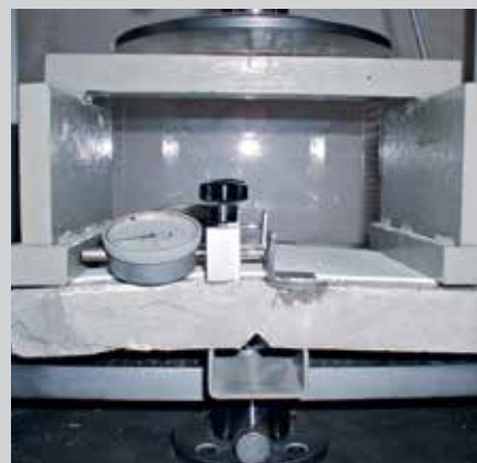
Statisk revneoverbygningsprøvning iht. EN 1062-7 (metode A)
