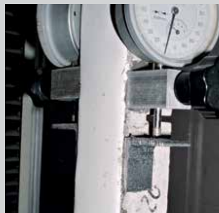
Dynamisk revneoverbygningsprøvning iht. EN 1062-7 (metode B)
