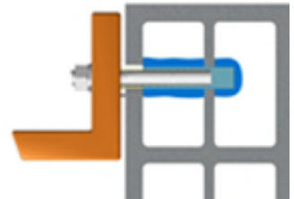
Kotvení do dutých bloků
